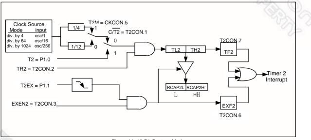
Figure 14. 16-Bit Capture Mode
